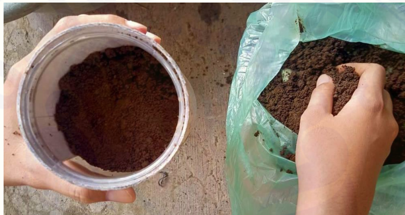
Gambar 3. 5 Pengisian tanah ke dalam tabung
