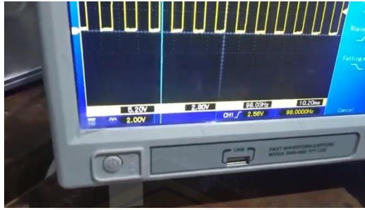
Gambar 7 Hasil pengukuran frekuensi luaran driver motor
