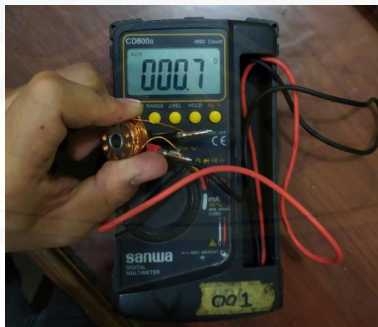
Gambar 3 Pengukuran resistansi motor
