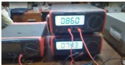
Gambar 9 Hasil pengukuran tegangan AC antar fasa luaran driver menggunakan avometer
