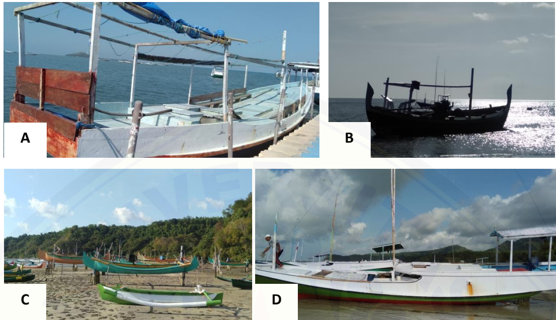
Gambar 8. Foto Macam Kapal. (A) Pajeng (Payang) (B) Konteng (Kursin) (C) Jhukung (Jukung) (D) Kalothok (Kalotok) (Sumber: Dokumentasi Pribadi, 2019).
