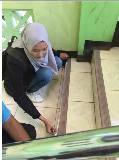
Pengukuran lebar tangga darurat
