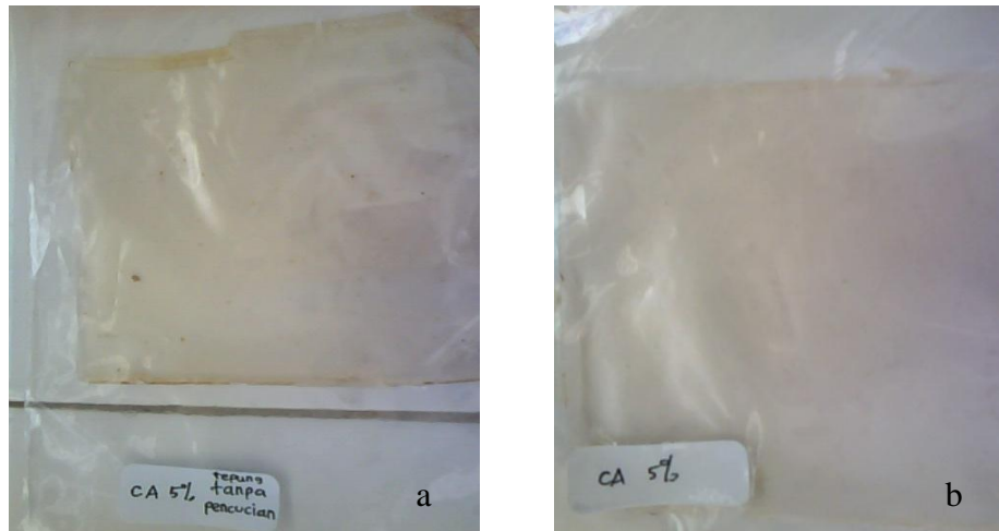
Gambar 4.3 Kopolimer pati sagu tanpa proses preparasi (a) dan dengan proses preparasi(b).
