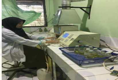
Gambar 3.9 Uji Absorbansi Konsentrasi Timbal dengan AAS
