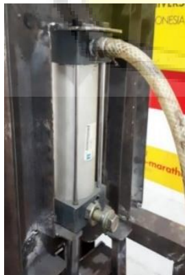
Gambar 2. Mekanisme pemberian beban oleh silinder pneumatic .
